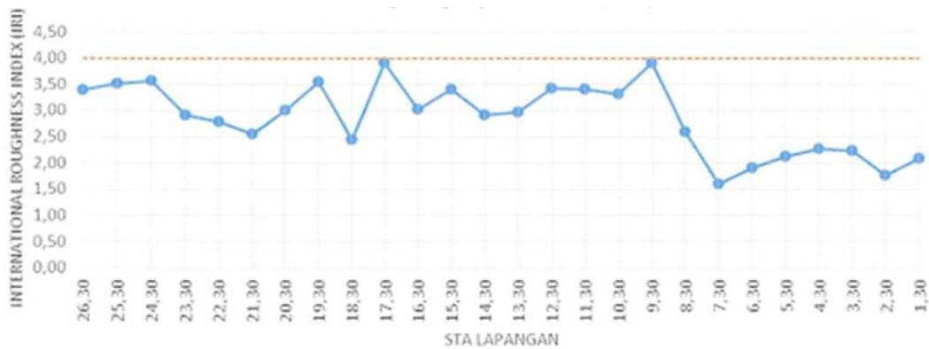
**Gambar 3.** Grafik Hasil Pengujian Indeks Ketidakrataan (Roughness) Ruas Jalan Tol Jakarta-Tangerang Pada Lajur 1
