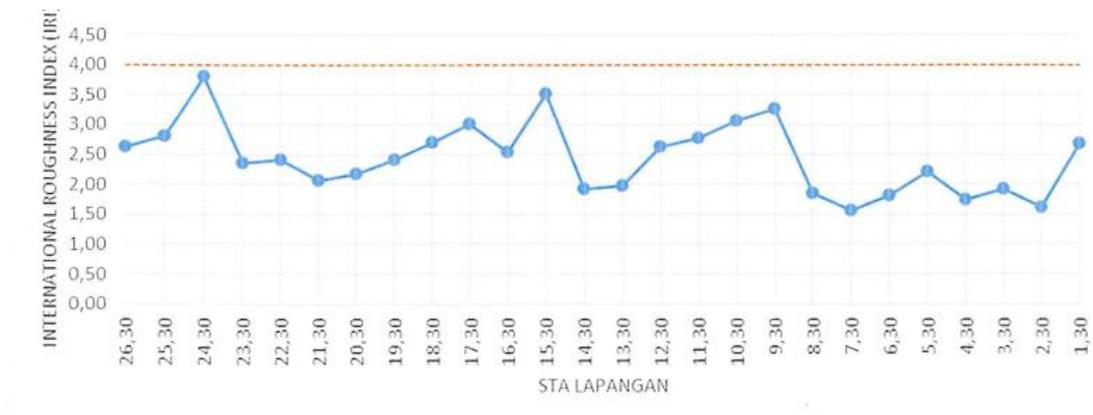
**Gambar 4.** Grafik Hasil Pengujian Indeks Ketidakrataan (Roughness) Ruas Jalan Tol Jakarta-Tangerang Pada Lajur 2
