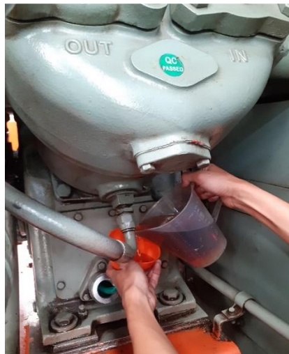
Gambar 1 Pengisian Minyak Pelumas Kompresor pada Lokomotif
