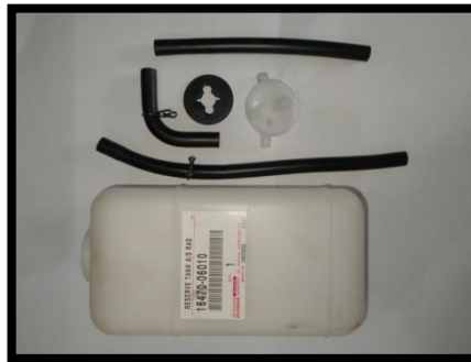
Gambar 4. Oil Catch Tank dengan Filter Busa/Kawat Stainless 1 Micron
