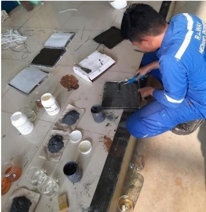
**Gambar 6.** Produksi komposit dengan metode *hand lay up*
