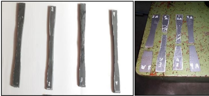
Gambar 8. Spesimen uji Tarik dengan standar ASTM D-638
