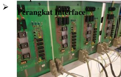
Perangkat interace berfungsi sebagai penerus antara output sistem Kendali dengan perangkat lampu lalu lintas. Perangkat ini terdiri dari kompponen elektronika yang berfungsi untuk merubah signal yang dikeluarkan dari sistem
